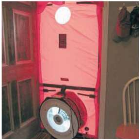
Door opening exhaust fan
